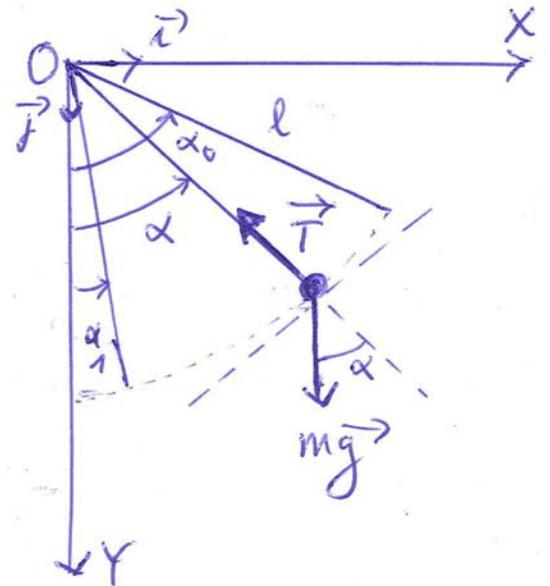
a) En  $\alpha_0$ , l'énergie mécanique est:  $E_M = -mgl \cos \alpha_0$
