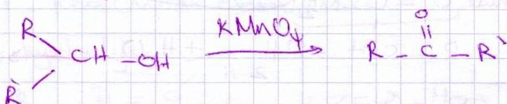
\* autre oxydants : CrO<sub>3</sub> /  $\text{CrO}_3/\text{O}_2$  réactif plus sélectif que KMnO<sub>4</sub>  $\Rightarrow$
