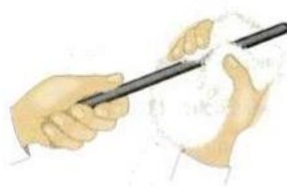
1. نقوم بذلك جسم بواسطة قطعة من الصوف فتظهر عليه شحنة كهربائية مقدارها
