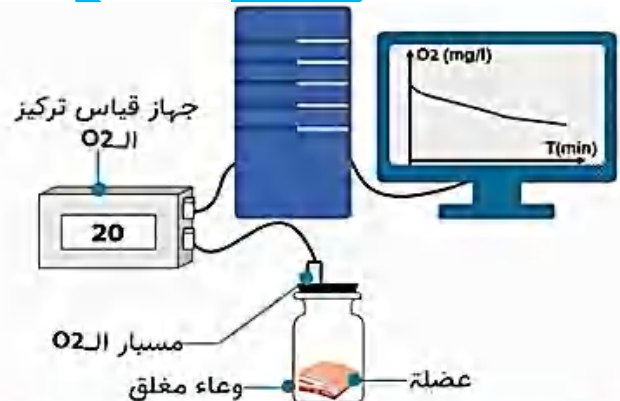
قياس تركيز ثنائي الأوكسجين باستعمال الـ EXAO
