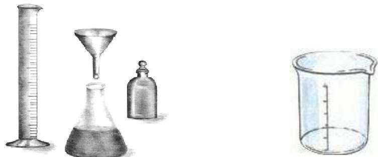
لقياس حجم سائل في المختبرات نستعمل الأواني المدرجة، وأهمها: **المخار المدرج** éprouvette gradué.
