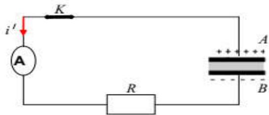
**4- المعادلة التفاضلية لتطور التوتر الكهربائي  $u_c$  :**
