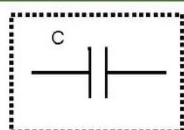
هي عناصر كهربائية قادرة على تخزين شحنة كهربائية، تتالف من صفيحتين معدنيتين (لبوسين) يفصل بينهما عازل كهربائي. تتميز بسعة نرمز لها بالرمز  $C$  وحدتها ( $F$ )
