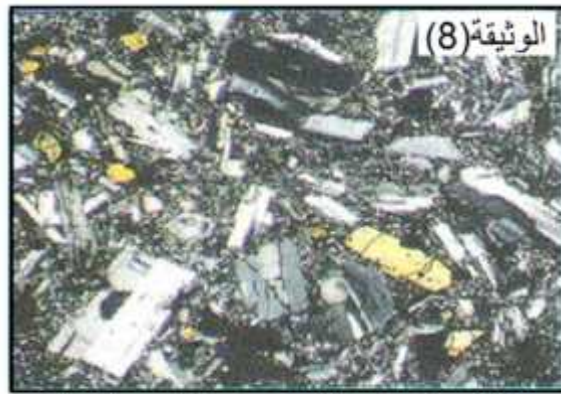
صورة لشريحة صخر الأنديزيت تحت المجهر المستقطب
