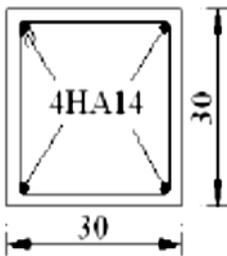
المعطيات :  $Nu=150KN$  ،  $Nser=130KN$ • الفولاذ من نوع FeE400 ;  $\gamma_s = 1.15$  ,  $\eta = 1.6$ • مقاومة الخرسانة :  $f_{c28} = 2.10MPa$  حالة التشققات ضارة جدا . سمك التغليف  $c=2$  cm
