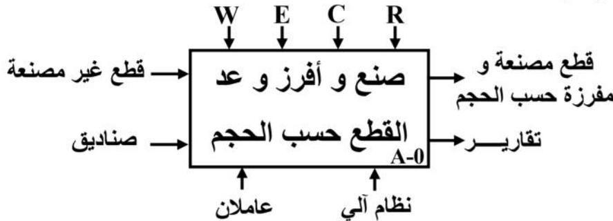
W: طاقة كهربائية و هوائية ( $E_E + E_P$ )
