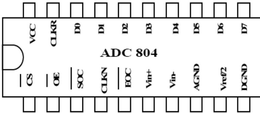
الدارة المنمجة ADC 804 :  $V_{ref}/2 = 2.56\text{ v}$
