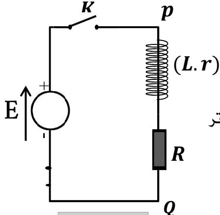
لتحديد المقادير المميزين في الوشيعة (ذاتيتها  $L$  والمقاومة الداخلية  $r$ ) ، انجز التلاميذ التركيب التجاري الممثل في الشكل - 14 - عند اللحظة  $t = 0$  ، تم اغلاق القاطعه وتبعدنا بواسطة راسم الاهتزاز ذو ذاكرة تغيرات كل من التوتر  $u_R(t)$  بين طرفي الناقل الأومي ذي المقاومة  $100\Omega$  و التوتر  $u_{pQ}(t)$  بين طرفي المولد الكهربائي ، فتم الحصول على المنحنيين  $a$  و  $b$  الممثلين في الشكل - 15 -
