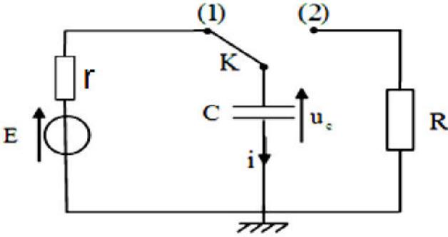
مكثفة سعتها C تم شحنها تحت توتر ثابت ( E = 12V ). ثم أعيد تفريغها في ناقل أومي مقاومته R = 10<sup>5</sup> Ω .
