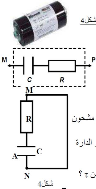
المكثفات الفائقة نوع يتميز بسعة من رتبة ألف فاراد وبتوتر شحن 2,7V. تكافئ هذه المكثفات ثنائي قطب MP يحتوي على التسلسل على مكثفة ذات سعة كبيرة C و ناقل أومي مقاومته ضعيفة R (شكل 4) يتميز هذا النوع من المكثفات بخصائص تقنية مدونة في الجدول التالي :
