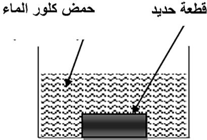
وضع مخبري كمية من محلول حمض كلور الماء في اناء يحتوي على قطعة من الحديد (الوثيقة 1). فلاحظ انطلاق غاز وتآكل القطعة الحديدية وتشكل محلول جديد يدعى كلور الحديد الثنائي.
