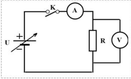
التركيب التالي يسمح بقياس شدة التيار الكهربائي المار في المقاومة R حسب قيمة التوتر المتغير U والنتائج المحصل عليها مبيّنة في الجدول أدناه.
