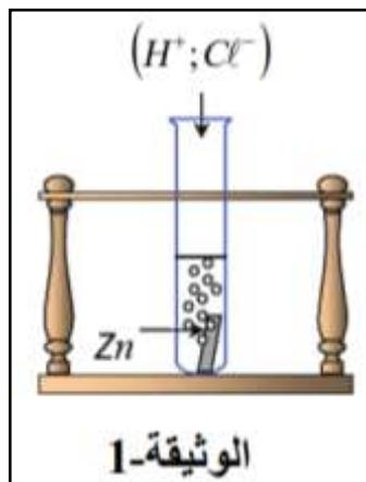
نسكب كمية كافية من محلول حمض كلور الماء ( $H^+$ ,  $Cl^-$ ) في أنبوب اختبار يحتوي على صفيحة معدنية من الزنك (Zn)، فينطلق غاز ويتشكل محلول شاردي هو كلور الزنك ( $Zn^{2+}$ ,  $2Cl^-$ ) كما في (الوثيقة-1).
