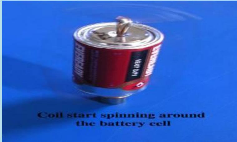
**المحرك الكهربائي (نموذج 2)****الأدوات:** سلك نحاسي - بطارية 1.5 فولت - مغناطيس قوي - مسمار
