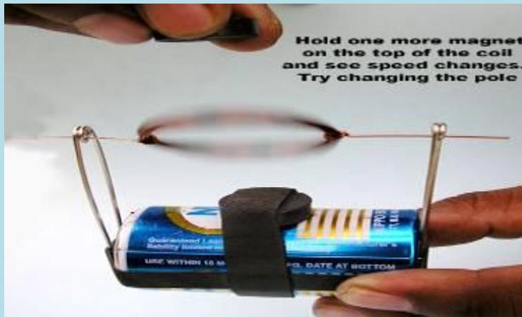
أيضا الصورة التالية نموذج رابع للمحرك الكهربائي ولكنه مشابه للنموذج الثالث .
