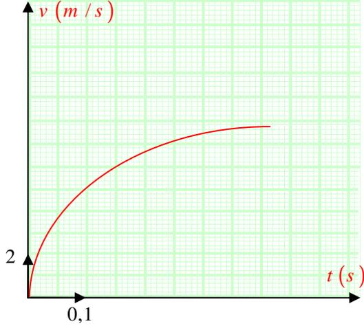
$$v(t) = 1,14 \cdot (1 - e^{-\frac{t}{0,132}}) \quad \text{حيث } v(t) \text{ مقدرة بالـ } m \cdot s^{-1}$$
